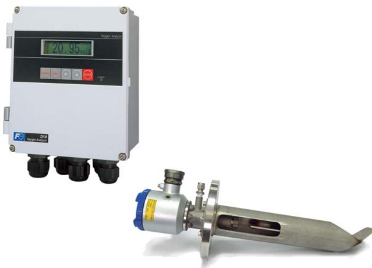
Analizador de oxígeno en continuo para gases de combustión FUJI ZKM
