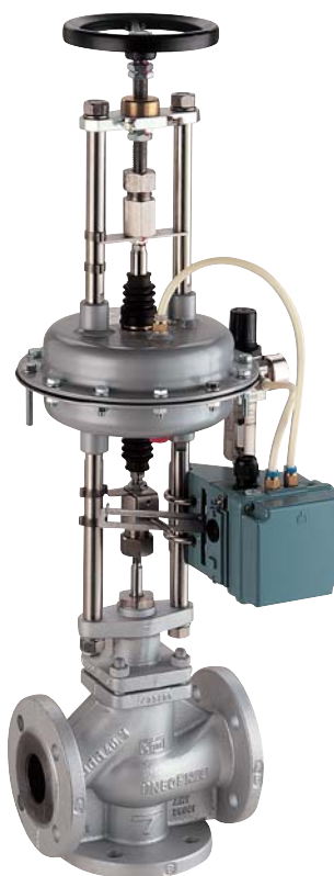
331 Válvula tres vías con actuador neumático, posicionador y mando manual de emergencia
